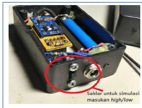
Gambar 12. Simulasi tanda bahaya dengan memberikan status high di pin masukan TR-52B.
