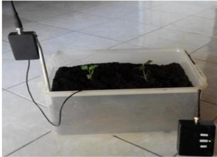
**Gambar 5** Sistem pemantau kelembaban tanah
