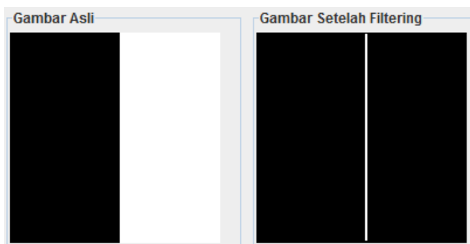
Gambar 9 Hasil pengujian deteksi tepi pada objek garisHorizontal.jpg
