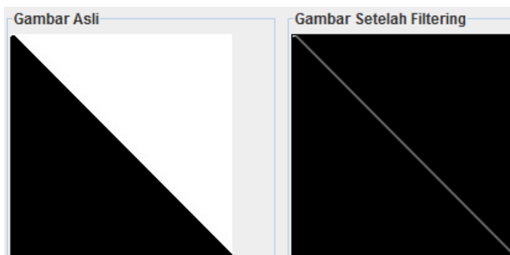
Gambar 9 Hasil pengujian deteksi tepi pada objek garisHorizontal.jpg
